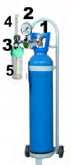
Slika 2-10. Aktiviranje boce za kiseonik: 1- glavni ventil, 2-manometar, 3-regulator na rotametu, 4-plovak na rotametu, 5-ovlaživač
